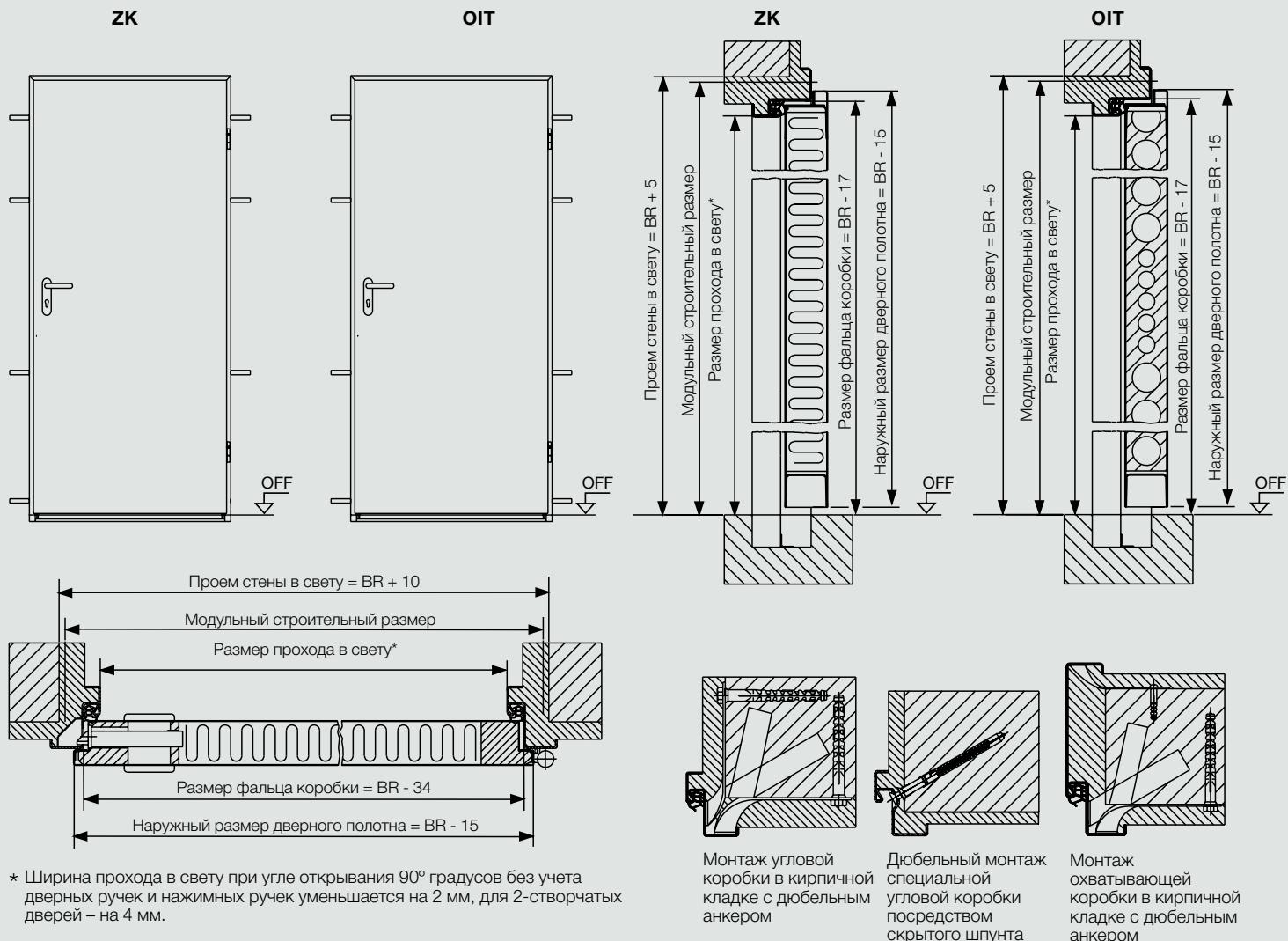
\* Ширина прохода в свету при угле открывания 90° градусов без учета дверных ручек и нажимных ручек уменьшается на 2 мм, для 2-створчатых дверей – на 4 мм.
