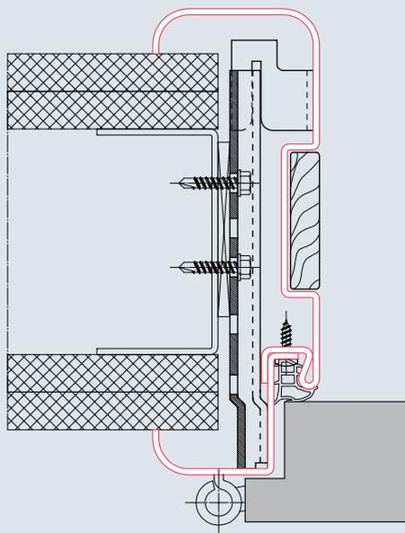
**Профиль охватывающей коробки сост. из двух частей, с филенкой в откосе дверного проема**
