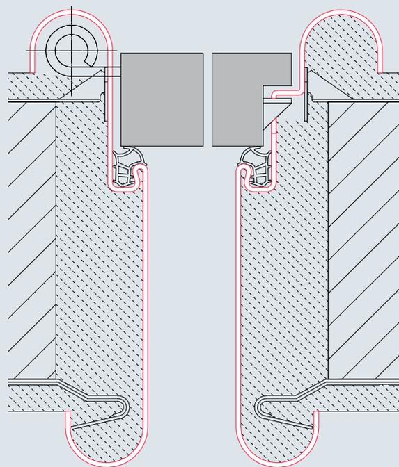
**Профиль охватывающей коробки, сост. из одной части, с круглыми зеркалами**
