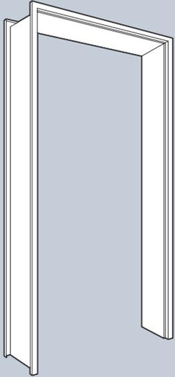
**Коробки, состоящие из одной части,** для массивных стен и для монтажа вдоль каркасных стен
