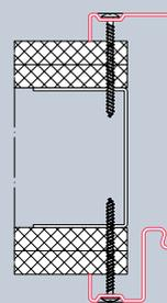
**Охватывающая быстромонтируемая коробка для каркасных стен** профиль 21120 с винтовым креплением зеркала коробки
