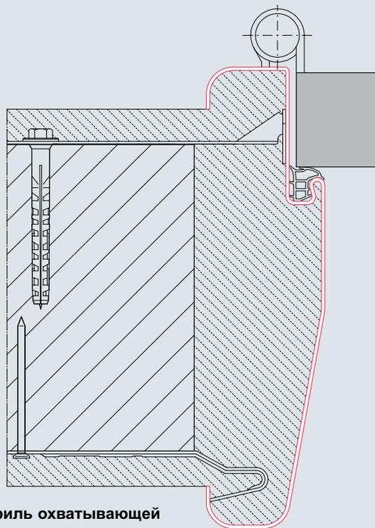
**Профиль охватывающей коробки, сост. из одной части, со скосом проема и закруглениями**
