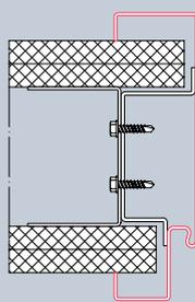
**Охватывающая коробка для каркасных стен** профиль 21120
