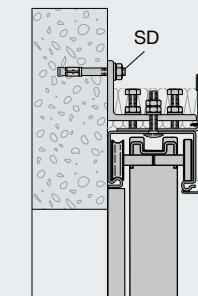
Только в комбинации с железобетонной перемычкой согласно статическому расчету. Перемычка в соответствии с длиной направляющих шин должна находиться над зоной проема ворот.
